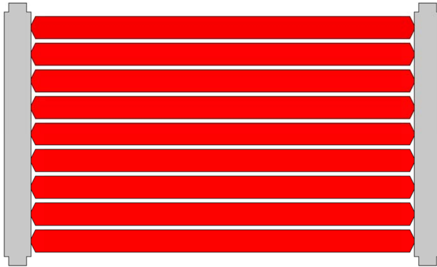
Abbildung 22: Verwendung von blasgeformten Bauteilen bei einem Kunststoffabsorber
