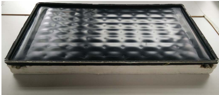
Abbildung 37: Prototyp mit rückseitiger Isolierung aus Polystyrol (ohne Abdeckung)
