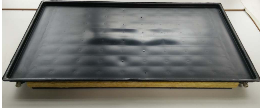
Abbildung 36: Prototyp mit rückseitiger Isolierung aus Glaswolle (ohne Abdeckung)
