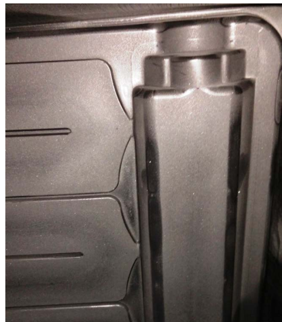
Abbildung 32: Optimierte Ausführung der Kunststoffabsorber (Links: Strömungskanäle. Rechts: Detailansicht des Anschlussbereichs)
