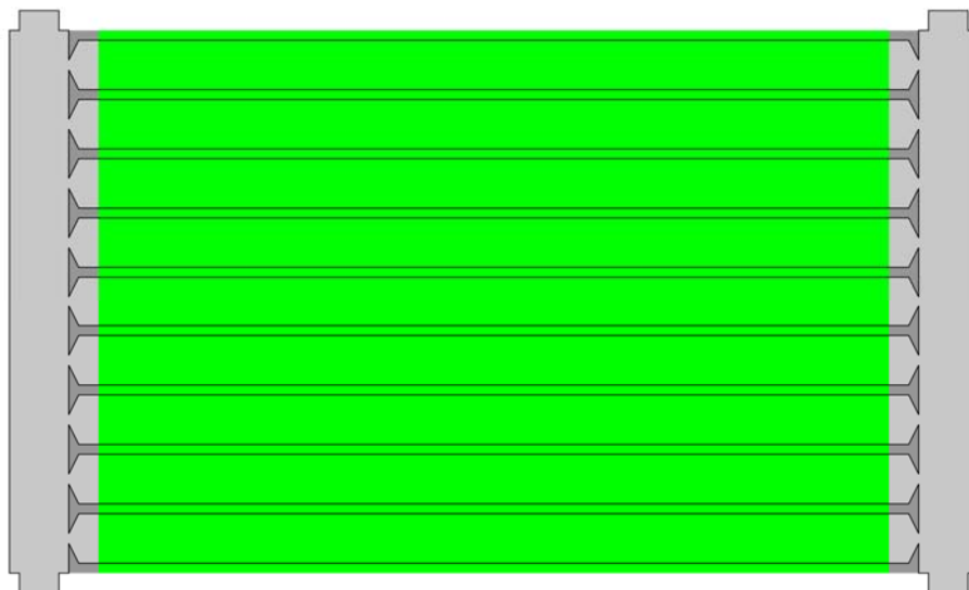
Abbildung 20: Verwendung von extrudierten Bauteilen bei einem Kunststoffabsorber
