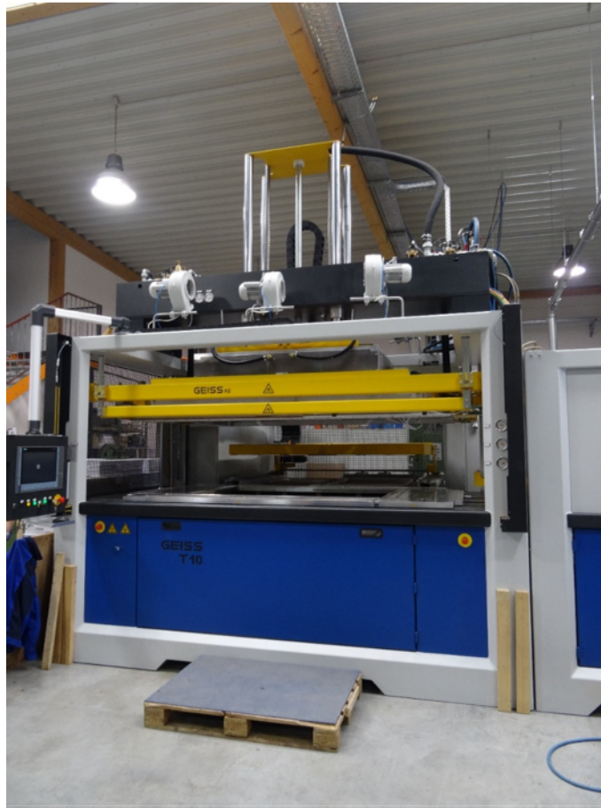
Abbildung 28: Außenansicht der Twinsheet-Thermoforming-Anlage vom Typ Geiss T10
