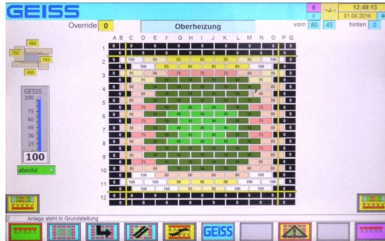
Abbildung 33: Definition der Temperaturverteilung bei der Twinsheet -Fertigung
