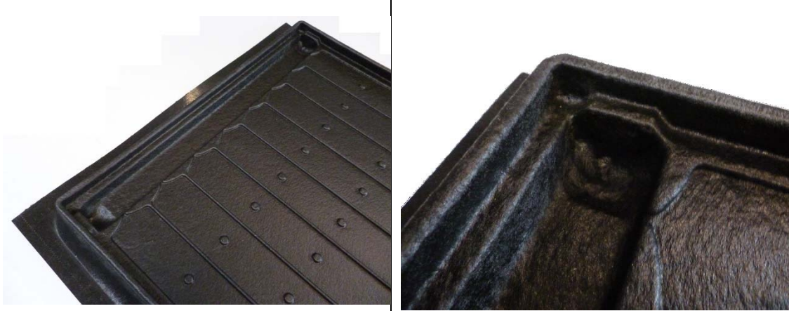
Abbildung 31: Ergebnisse der Prototypen-Fertigung mit einem Glasfaseranteil von 20% und einer maximalen Glasfaserlänge von 20 mm (Links: Gesamtansicht / Rechts: Detailansicht des Anschlussbereichs).
