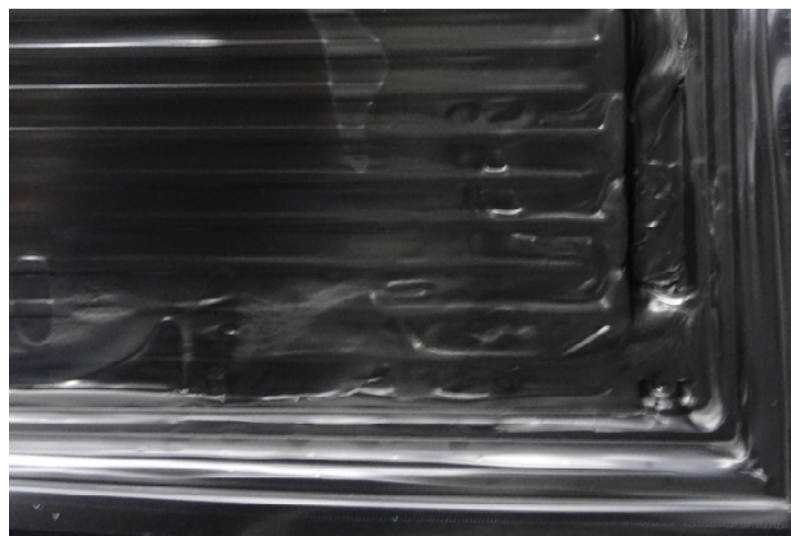
Abbildung 34: Mangelhaft gefertigte Absorberstruktur aufgrund nicht-optimaler Prozessparameter
