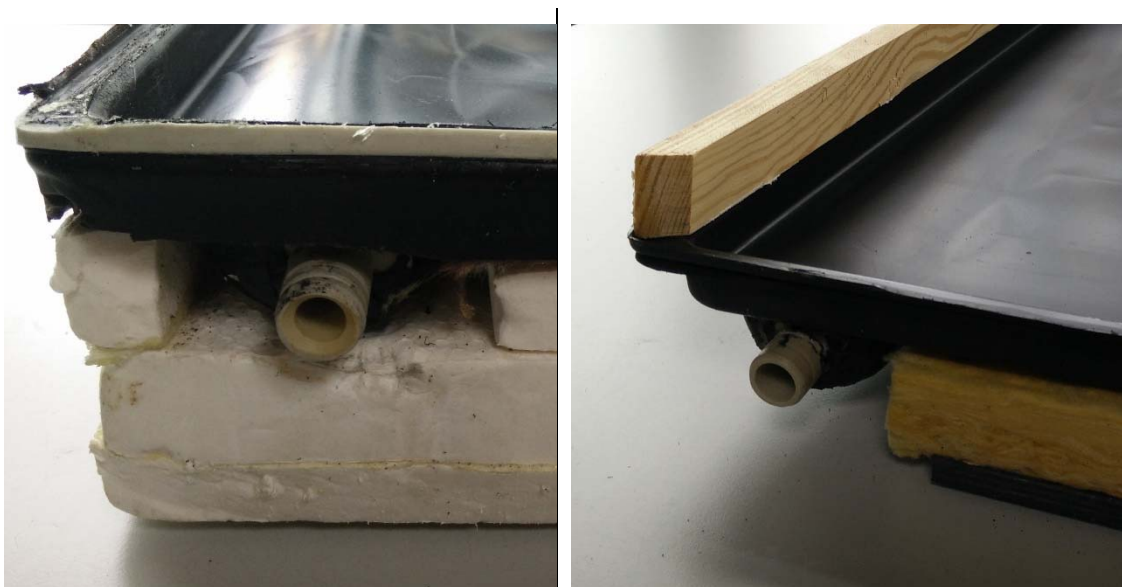
Abbildung 38: Detailansichten der Prototypen. Links: Variante mit rückseitiger Isolierung Polystyrol (ohne Abdeckung). Rechts: Variante mit rückseitiger Isolierung aus Glaswolle (ohne Abdeckung) und Teile des umlaufenden Rahmens (Test der Kollektoren mit größerem Abstand zw. Absorber und Abdeckung).
