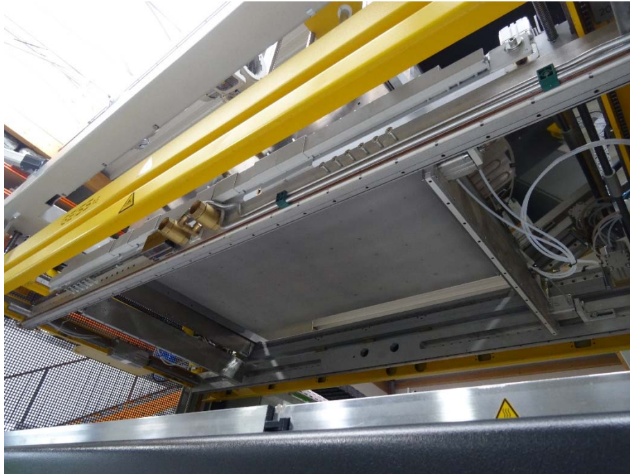
Abbildung 29: Innenansicht der Twinsheet-Thermoforming-Anlage vom Typ Geiss T10 inkl. des Oberteils
