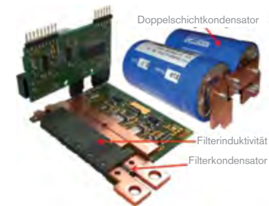
Abb1: Musteraufbau eines neuartigen Hochstromgleichspannungswandlers mit einer Stromtragfähigkeit von 200A zur dynamischen Stabilisierung des 14V Energienetzes in einem Kraftfahrzeug [3].
