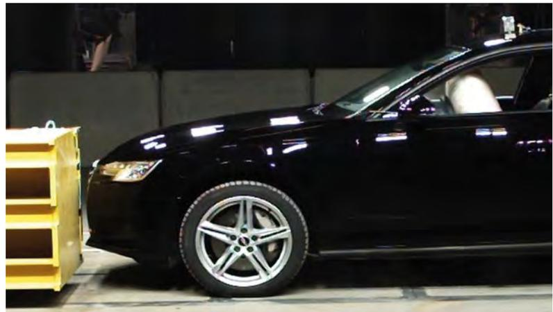
Abb. 1: Airbag, ausgelöst in der Pre-Crash-Phase vor der unvermeidbaren Kollision. Quelle: THI
